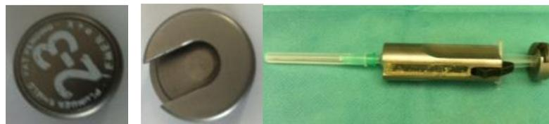
piston plombé avant/arrière à gauche et seringue avec protection plombé à droite
